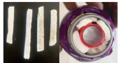
加工した発泡ポリスチレンは、空き缶の中に拍子木状に詰められ固体燃料となる。
